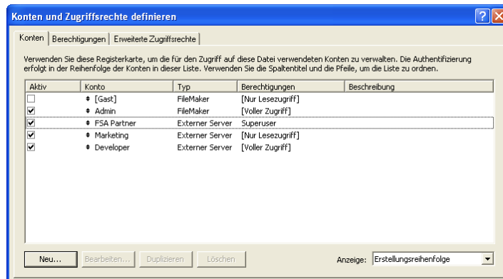
Abb. 12. Die Authentifizierungsreihenfolge bestimmt, welches Konto und welche dazugehörige Berechtigung der externen Authentifizierung gewählt wird, wenn ein Benutzer zu mehreren Domain-Gruppen gehört.
